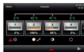
Vitotrol 350-C – základné zobrazenie kaskády pre štyri vykurovacie kotly na drevo
